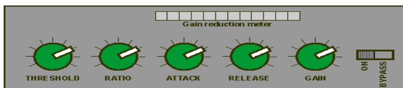
Parámetros ajustables para Compresor, Limitador y Expansor.
